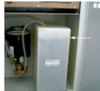
Figura S: 1-4 Depósito del refrigerante del husillo.
