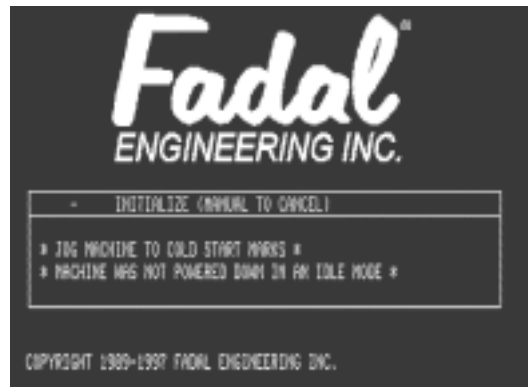
Figura S: 1-9 Visualización en pantalla cuando se ha desconectado incorrectamente la VMC.
