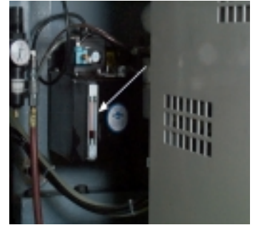
Figura S: 1-1 Depósito del aceite y mirilla.
